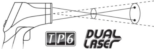
Для деактивации видимости лазерного луча снова нажать клавишу ⑥, символ лазера ⑯ гаснет.
