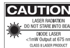
Ret aldrig laseren direkte eller indirekte - gennem reflekterende overflader - mod øjet.
