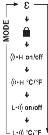
Med **valgtasten ekstrafunktioner (Mode)** 22 kan der foretages forskellige funktionsindstillinger. Med hvert tryk på Mode-tasten skifter TP6 til næste funktionsmodus (se billedet).
