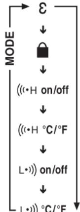
Med **valgknappen Tilleggsfunksjoner (Mode)** ㉒ kan du foreta ulike funksjonsinnstillinger. For hvert trykk på Mode-knappen skifter TP6 til neste funksjonsmodus (se figur).
