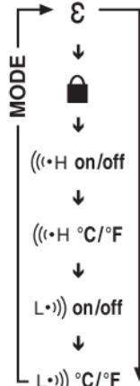
Med hjälp av **knappen Tilläggs-funktioner (Mode)** 22 kan man göra olika funktionsinställningar. För varje tryck på Mode-knappen växlar TP6 över till nästa funktionsläge (se figur).
