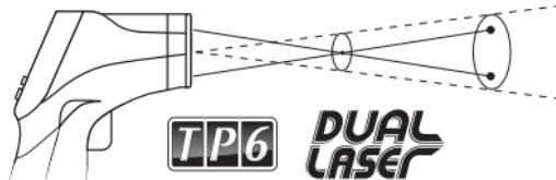
Pour désactiver la visibilité du rayon laser, appuyer à nouveau sur la **touche Laser Marche/Arrêt** ⑥, et le **symbole du laser** ⑯ s'éteint. Pour les mesures dans l'obscurité, il est possible d'activer ou de désactiver le rétroéclairage de l'afficheur à l'aide de la **touche Rétroéclairage** ⑦.
