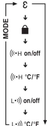
С помощью клавиши выбора дополнительных функций (Mode) ② можно настроить функции. С каждым нажатием клавиши Mode прибор ТР6 переходит в следующий режим (см. рисунок).
