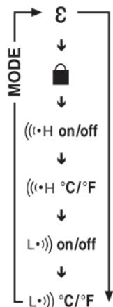
La touche de sélection des **fonctions complémentaires (Mode)** ② permet de procéder à différents réglages des fonctions. Avec chaque actionnement de la touche Mode, l'appareil TP6 passe au prochain mode de fonction (se reporter à la figure).
